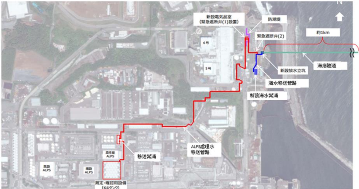
圖 23. ALPS 處理水從測定與確認用設備(K4 區)到排放之整體路徑鳥瞰圖
