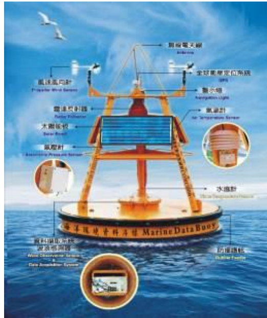
圖 68. 本計畫浮標系統規劃參考國家海洋研究院太平島資料浮標。該浮標系統係由國立成功大學近海水文中心設計和製作，觀測項目可包含水上和水下。科儀設備可由浮標體上的太陽能板透過纜線或直接經由鋼纜供電。觀測資料採用衛星和 4G 雙通道即時傳輸技術；近域傳輸以 4G 為主，在無 4G 基地台覆蓋的遠域或當 4G 訊號微弱時，系統將自動切換為衛星通訊，使觀測資料的收集得以連續。
